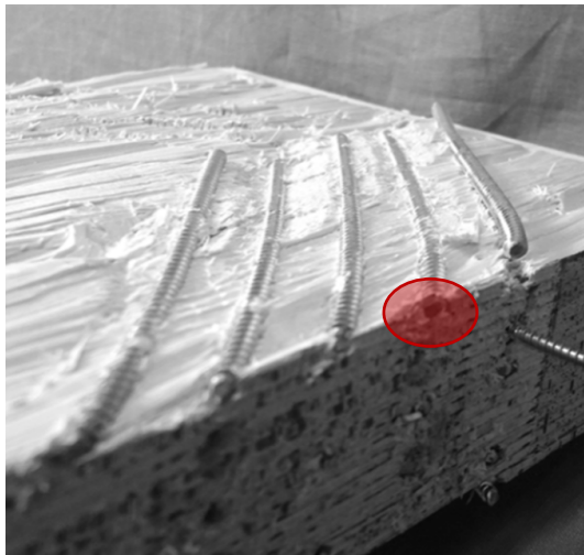
Abbildung 3.2 Herausforderungen im kreislauffähigen Bauen: Abreißen des Schraubenkopfes (links) [20], Verkrümmung der Stabachse durch Scherbeanspruchung (rechts) [21]
