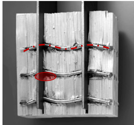
Abbildung 3.2 Herausforderungen im kreislauffähigen Bauen: Abreißen des Schraubenkopfes (links) [20], Verkrümmung der Stabachse durch Scherbeanspruchung (rechts) [21]
