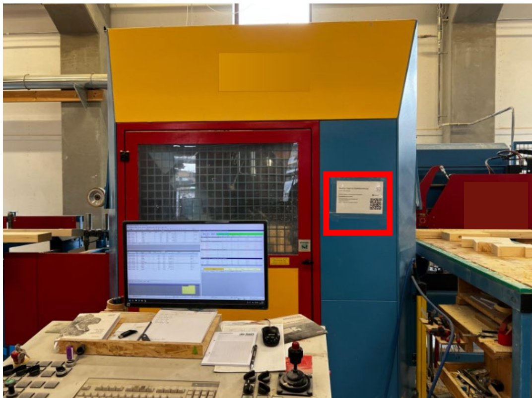
Abbildung 1.16 Poka Yoke in Form einer Checkliste an der Abbundanlage (siehe PDCA entlang eines Anwendungsfalles)
