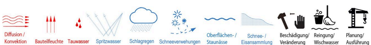
Abbildung 6.1 Übersicht der Einflussbereiche - Die verschiedenen Einflüsse auf die Holzbaudetails wurden anhand ihres Auftretens in drei Einflussbereiche gruppiert, um eine einfachere Anwendung im Rahmen des Forschungsprojektes zu ermöglichen. (rot: bauphysikalische Einflüsse, blau: umweltbezogene Einflüsse, schwarz: benutzungsbezogene Einflüsse)
